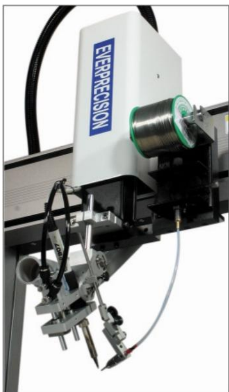
Оригинальная конструкция паяльной головки и устройства подачи припоя
